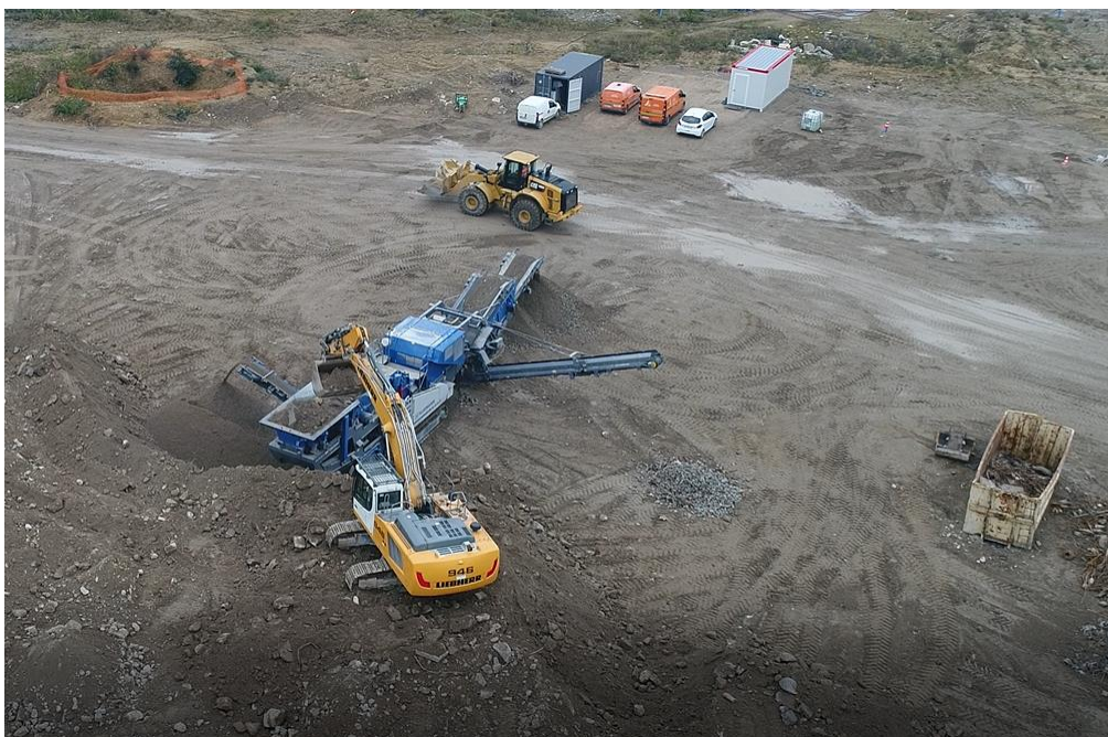
Figure 7 - Atelier de concassage (pelle d'alimentation, concasseur/cribleur, benne à ferraille et chargeuse)
